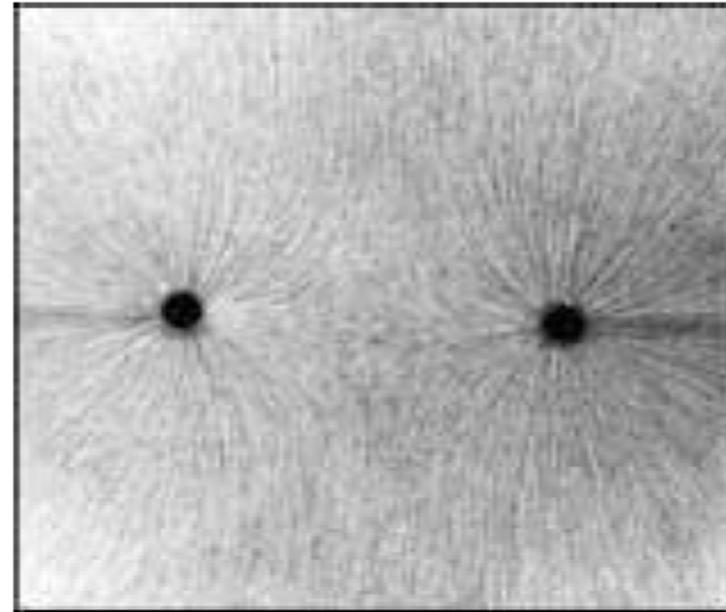
Imagen de partículas pequeñas suspendidas en aceite, alrededor de dos puntas conductoras con cargas opuestas.
