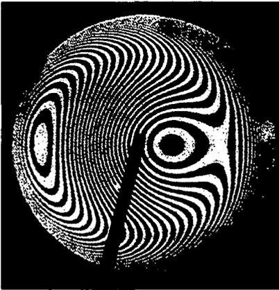
**Figura 37.19** Este patrón de interferencia asimétrico indica imperfecciones en el lente de un aparato de anillos de Newton. (De *Physical Science Study Committee*, Colegio de Física, Lexington, Mass., Heath, 1968.)
