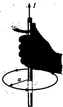
**Figura 30.3** La regla de la mano derecha para determinar la dirección del campo magnético que rodea un largo alambre recto que conduce corriente. Advierta que las líneas de campo magnético forman círculos alrededor del alambre.
